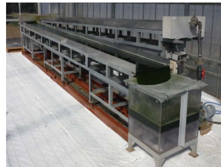
図: 藻類培養技術センター 農業用温室に設置した藻類大量培養装置
