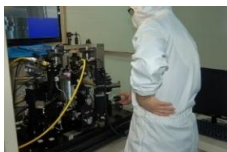
YAGレーザ融着固定
